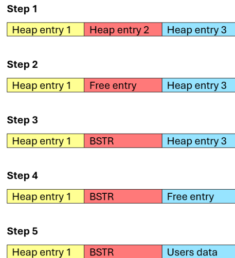
Figura 3.7: Esquema que representa el flujo de un grooming destinado a acomodar el heap en una estructura predecible. Fuente: propia
