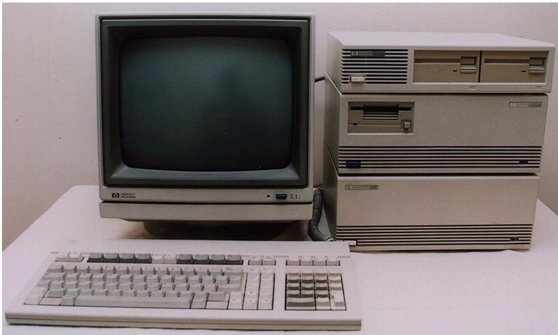
Figura IV.13: HP 9000/375 Turbo SRX dotada de subsistema gráfico,
