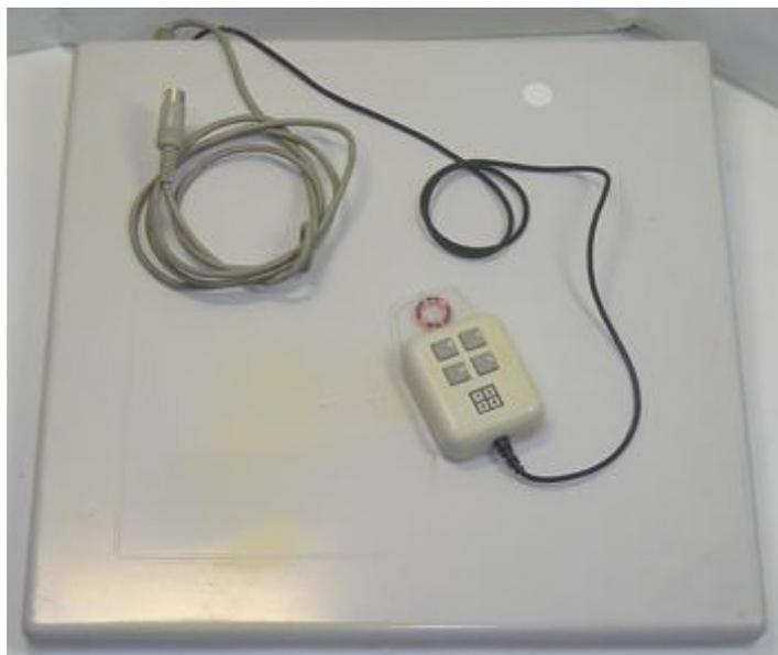
Figura 1.39: Terminal de digitalización BitPad de Summagraphics
