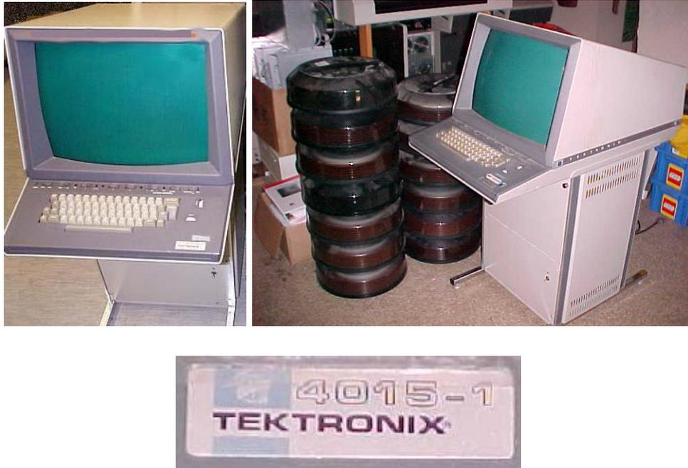
Figura 1.40: Terminal gráfica vectorial Tektronix 4015-1
