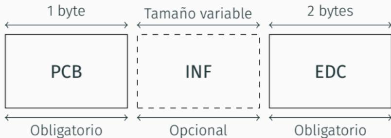
Figura 4: Bloque de transmisión de protocolo
