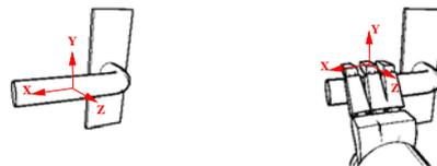
Figura 6. Sistema de referencia asociado a la manivela de la puerta (izq.) y sistema asociado a la tarea (dcha.)
