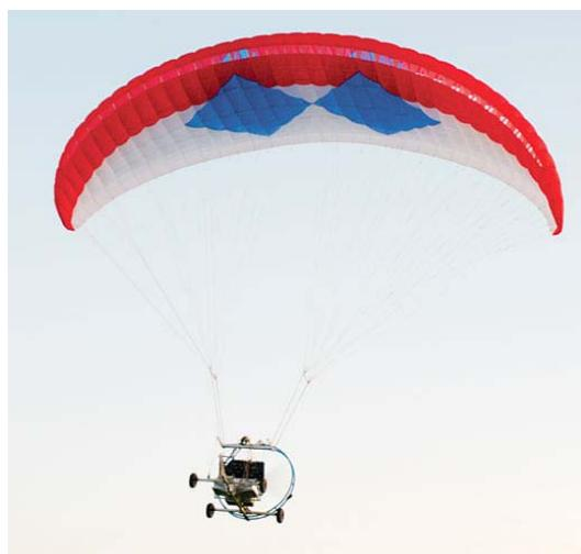
**Figura 5 Paracaídas “autónomo” (Cortesía Atair)**
