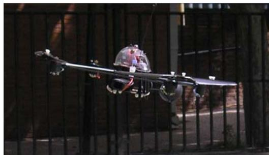
**Figura 3 Quad-Rotor autónomo (Cortesía Grupo de Robótica y Cibernética UPM)**
