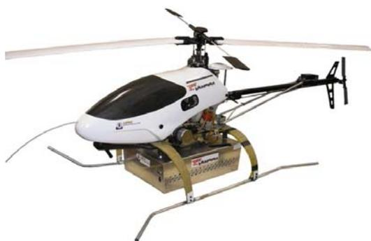
**Figura 4 Helicóptero autónomo (Cortesía Grupo de Robótica y Cibernética UPM)**
