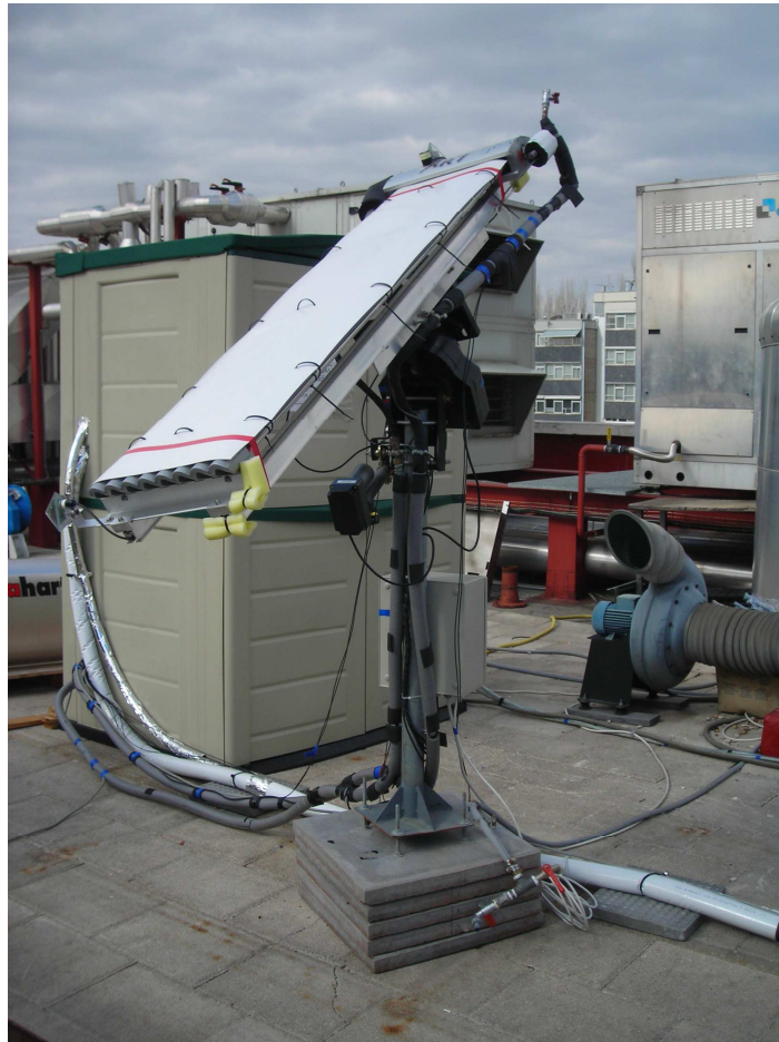
Figura 1.2. Seguidor solar Artysol (instalado en la facultad de Física de la UCM.)
