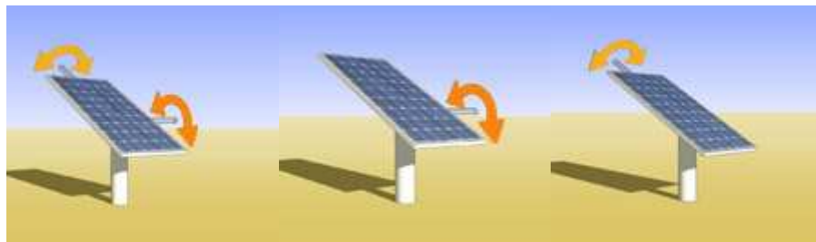
Figura 1.1. Tipos de seguimiento. Por orden de izquierda a derecha: Dos ejes. Un eje Este Oeste horizontal, en eje polar.
