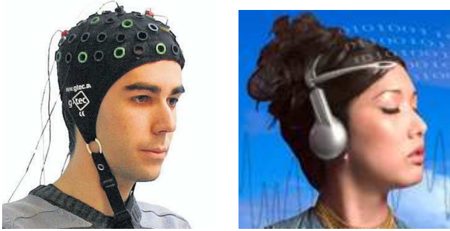
Figura 6. Montaje de gorro con sensores para medición de EEG clínico (gorro húmedo) y montaje comercial para aplicaciones lúdicas de la marca Neurosky (gorro seco).
