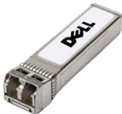
Imagen: Transceptor, SFP+, 10GbE, LR, 1310 nm, 10 km. Fuente: www.dell.com .
