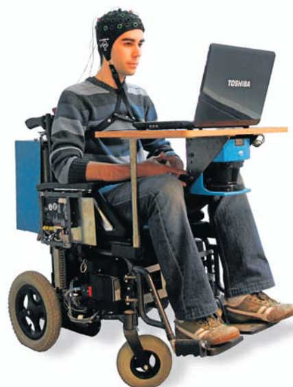
Figura 1: Prototipo silla de ruedas controlada por actividad cerebral.
