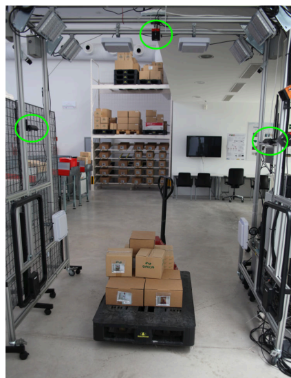
Figura 6: Configuración escogida de los dispositivos. Las dos Asus en los laterales y la Mesa SR 4000 en la parte superior. Las Asus registran la información de los laterales exclusivamente y la Mesa proporciona una vista de la parte superior de la escena, siendo su eje z perpendicular al plano del suelo. Las cámaras han sido señaladas en la imagen con círculos de color verde.
